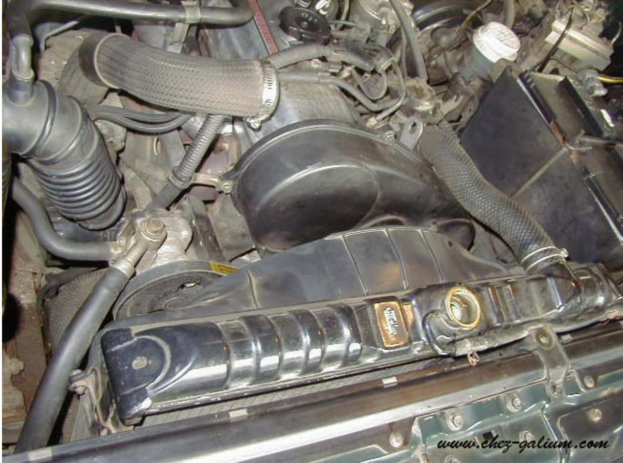
*Mise ne place du radiateur, des durites, de l'antigel et de l'intercooler..*
