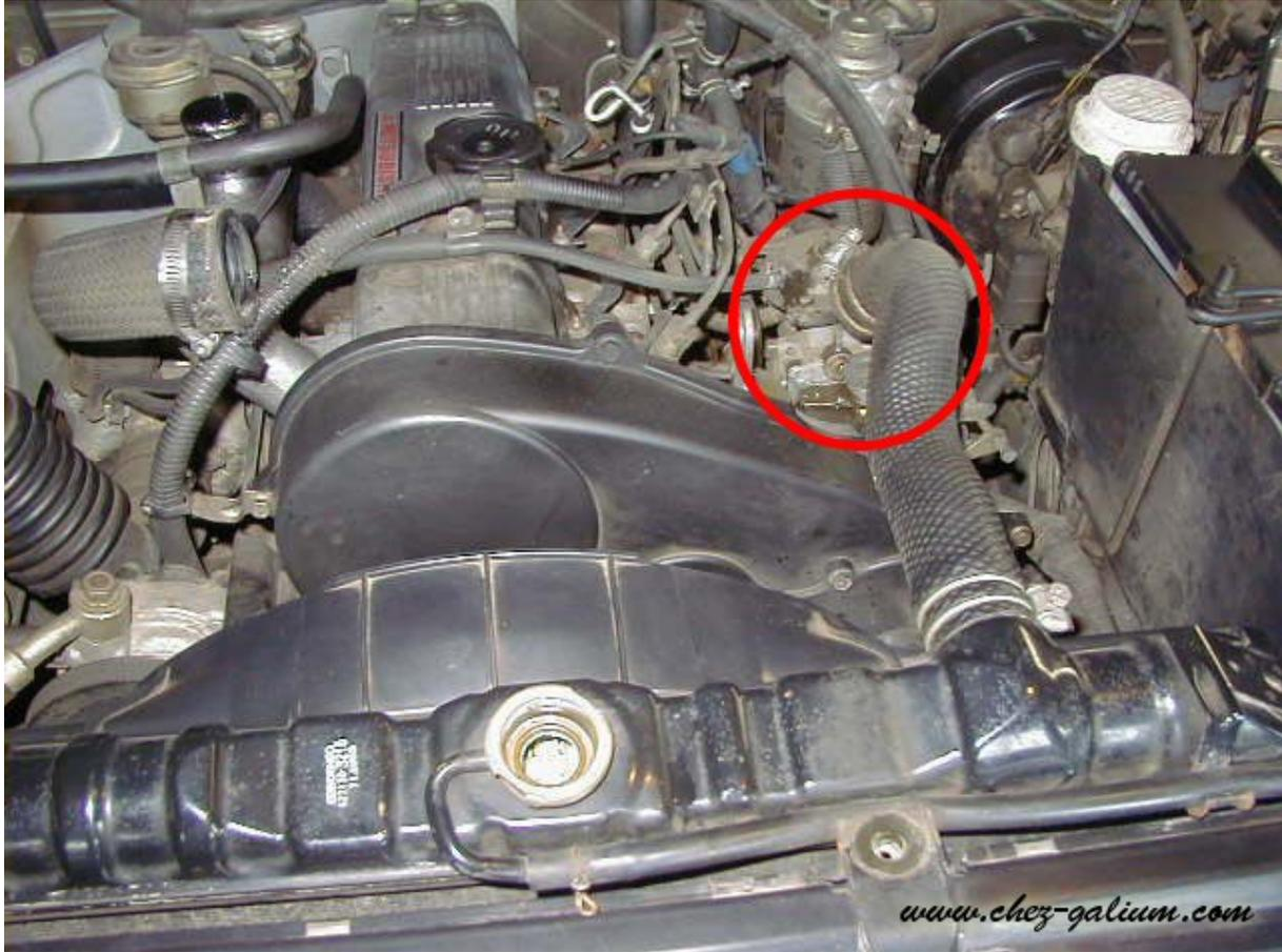
*Démontage de (en rouge) la durite supérieure du radiateur, coté bloc moteur.*
