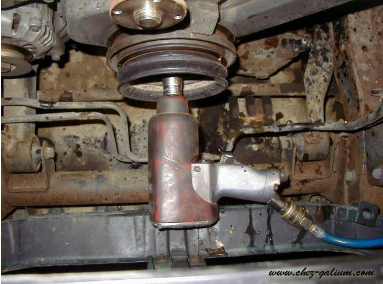
*Dépose du boulon central de la poulie de vilbrequin.*
