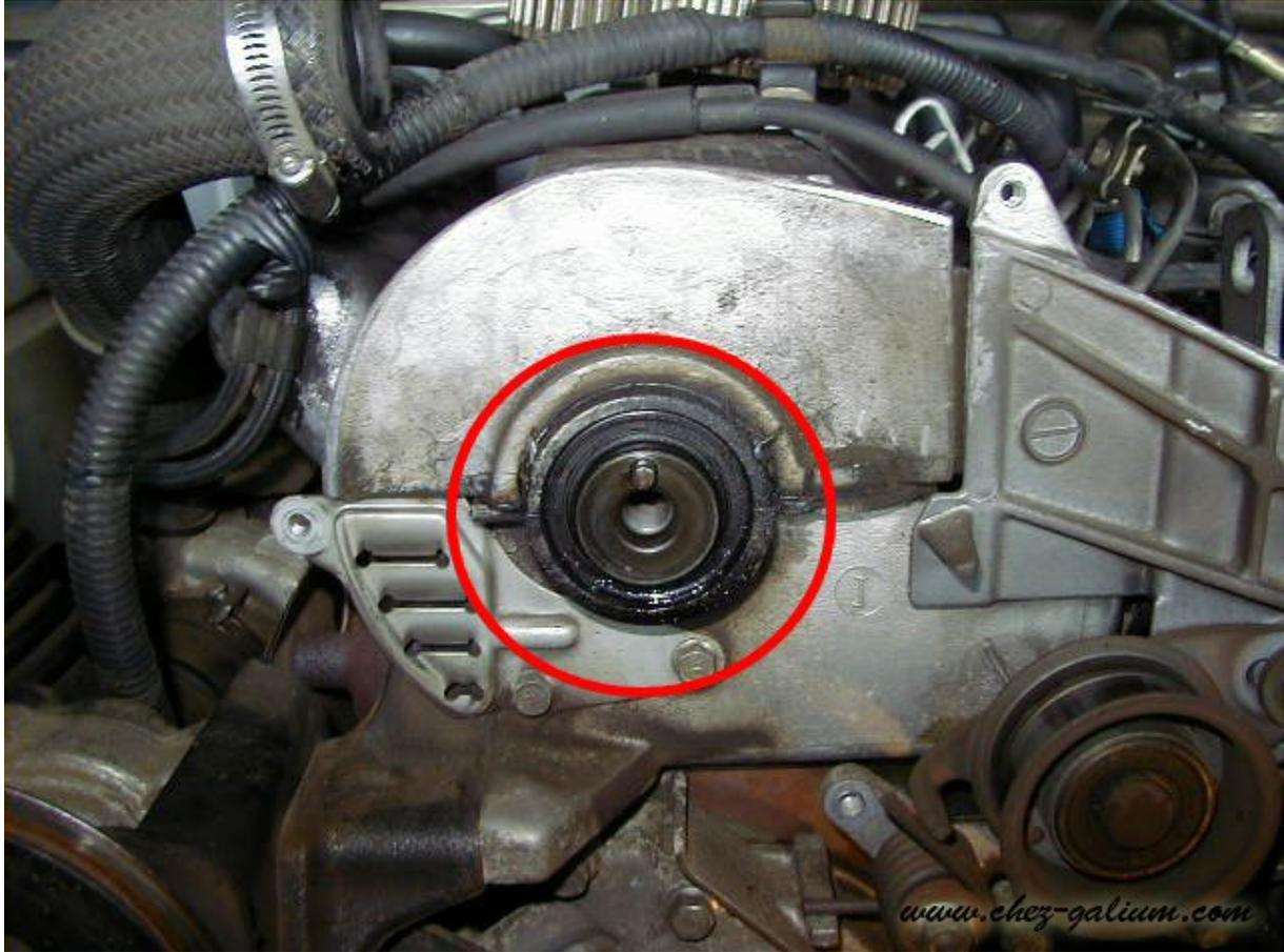
*Dépose de la poulie d'arbre à cames, pour le changement du (en rouge) joint spy.*
