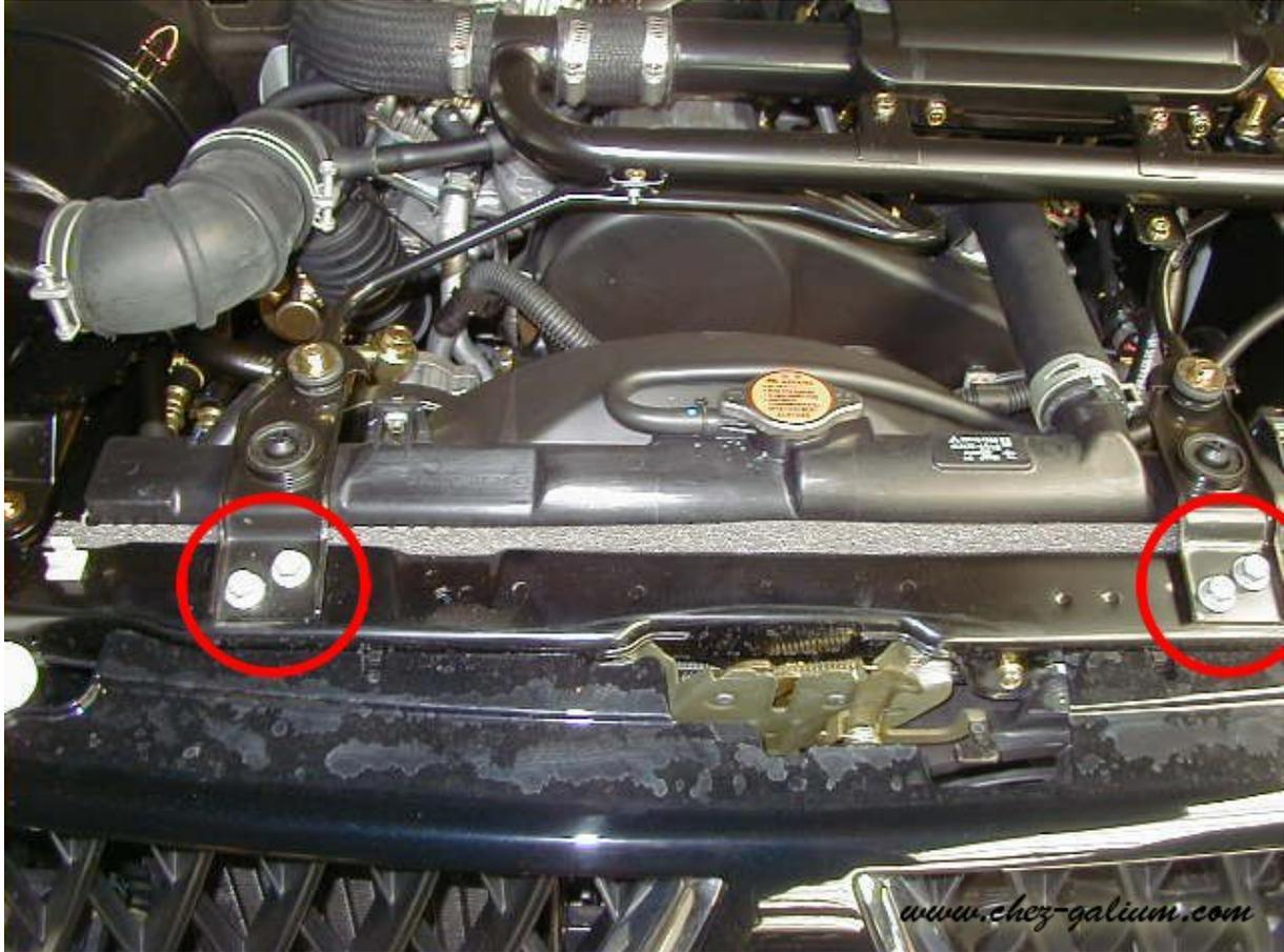
*Pour le 4D56 115cv ou 136cv, (en rouge) les fixations du radiateurs sont différentes.*
