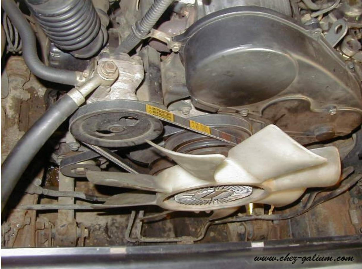
*Suivi par la mise en place des courroies. Bien tendre les courroies, et contrôlé le serrage des boulons du ventilateur.*
