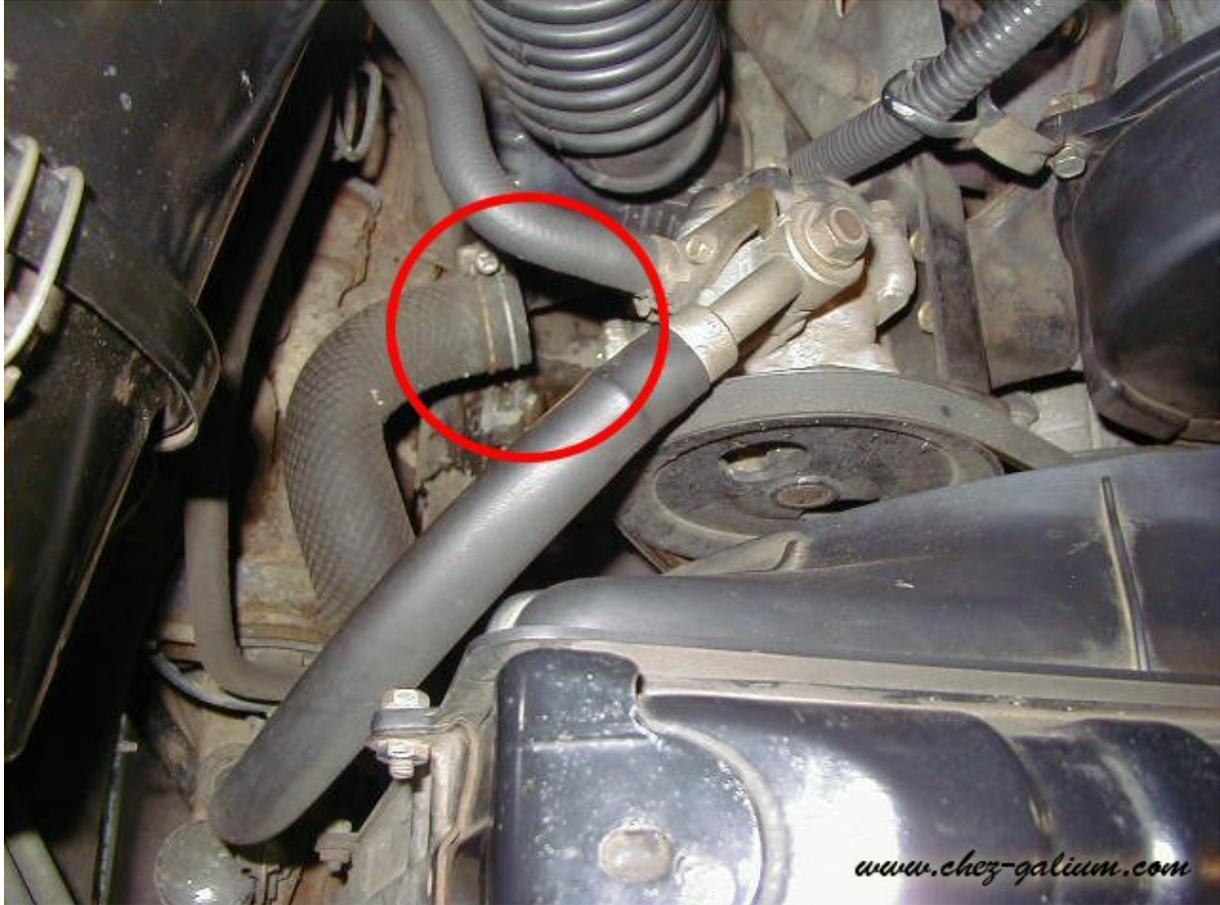
*Démontage de (en rouge) la durite inférieure du radiateur, coté bloc moteur, sous la pompe direction assistée.*
