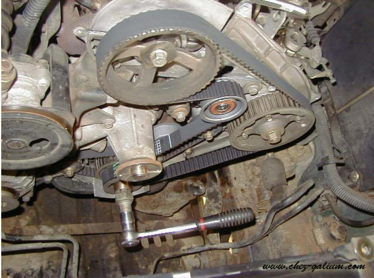
*Petit contrôle afin de vérifier que tout est ok, faire tourner le moteur (à la main), dans le sens horlogique de deux tours, révéfier les repères (à partir de la photo 29), contrôle de la tension des courroies, si nécessaire, débloquer les tendeurs afin que la courroie se retende et bloquer le tendeur.*
