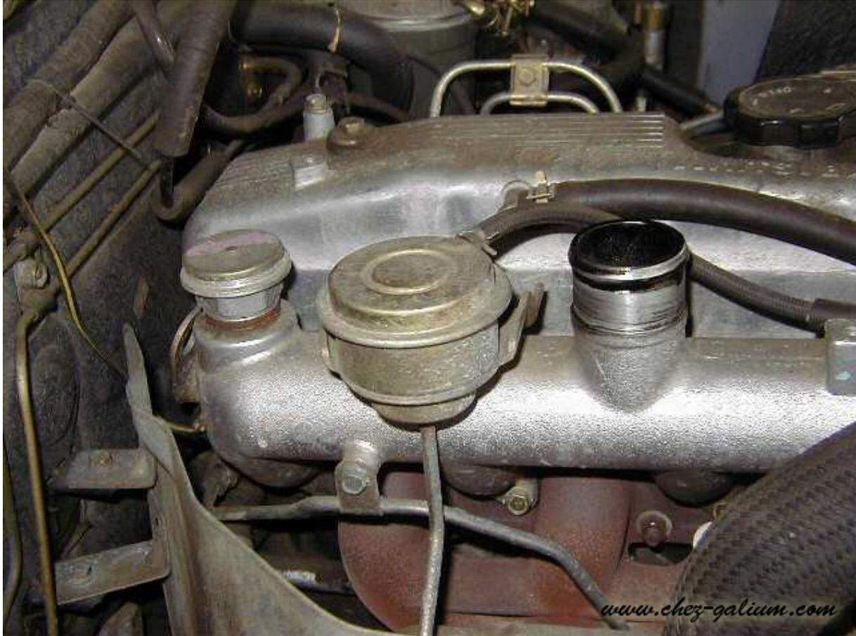
*Remettons la soupape en place avec les 2 nouveaux boulons.*
