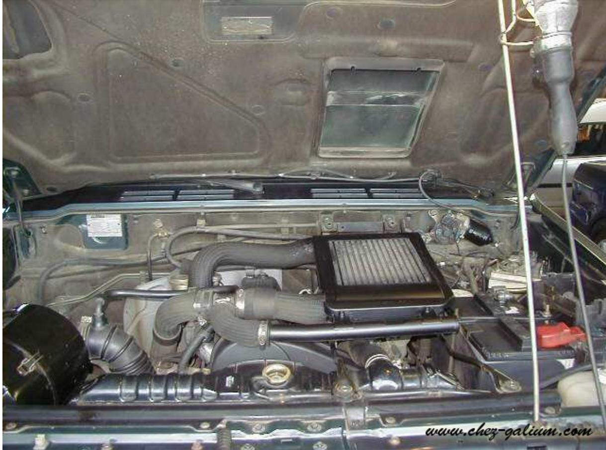
*Remontage de l'intercooler et petit test routier ...*
