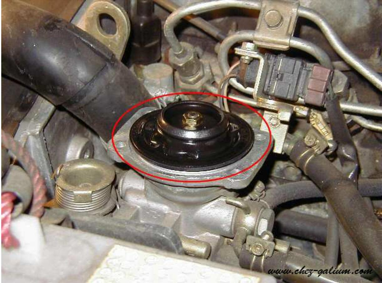
*Une fois les 4 vis enlevées, déposer le couvercle, la membrane avec sa bague de nylon et le ressort.*
