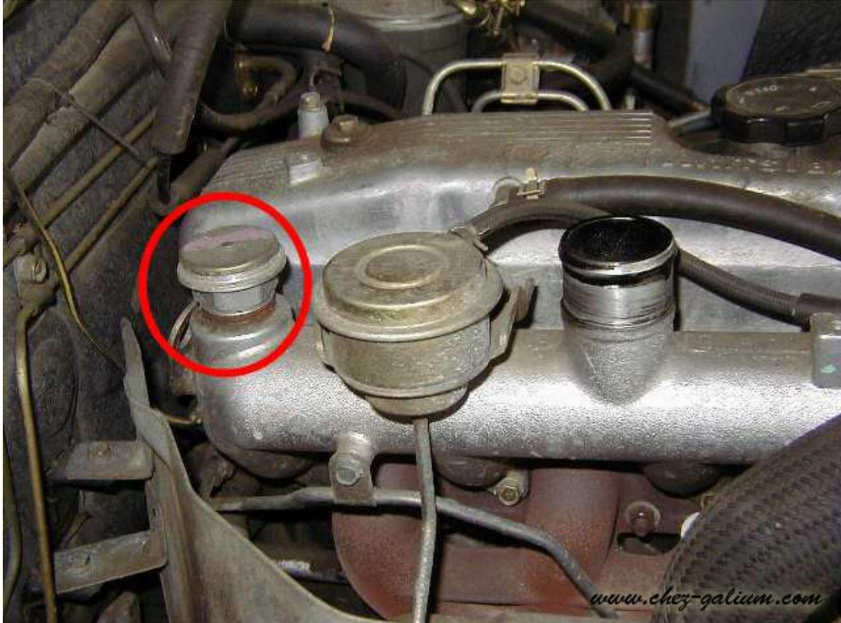
*La (en rouge) soupape de sécurité de surpression turbo.&nbsp;*
